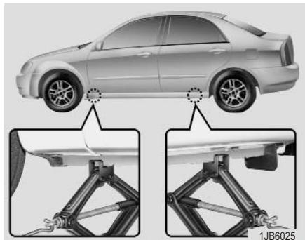
7. Основание домкрата необходимо поместить на твердую ровную поверхность. Расположите домкрат рядом со снимаемым колесом и подставьте его верхнее основание к специальному технологическому выступу на днище автомобиля, как показано на рисунке.
