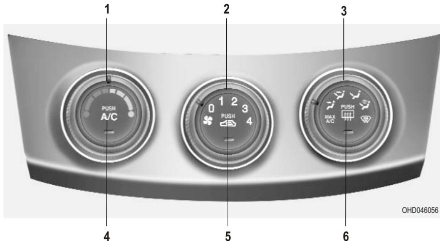
4. Кнопка включения кондиционера (дополнительное оборудование)
