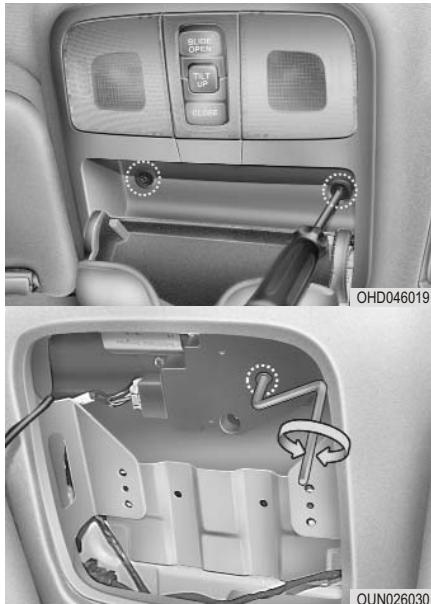
2. При помощи отвертки отверните два винта и снимите верхнюю консоль.
