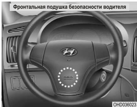
Ваш автомобиль оборудован дополнительной системой пассивной безопасности (надувными подушками безопасности) SRS. Наличие этой системы можно определить по наличию надписи “SRS AIR BAG”, имеющейся на крышке подушки безопасности в рулевом колесе и на накладке панели со стороны переднего пассажира над вещевым ящиком.
