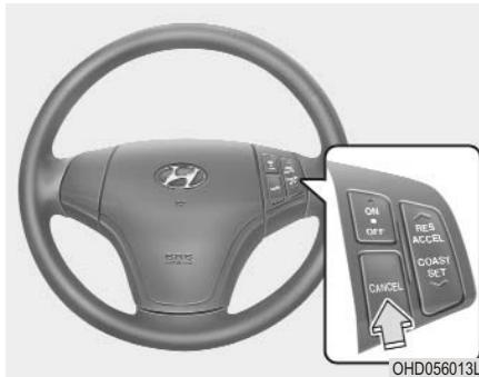
Каждое из этих действий отменит заданную скорость движения автомобиля (контрольная лампа CRUISE погаснет), но не выключит систему полностью. Если Вы хотите выбрать заданную ранее скорость движения, нажмите переключатель RES/ACCEL.
