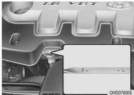
3. Выключите двигатель. Подождите приблизительно пять минут (бензиновый двигатель) / приблизительно десять минут (дизельный двигатель), для того чтобы моторное масло стекло в поддон картера.
