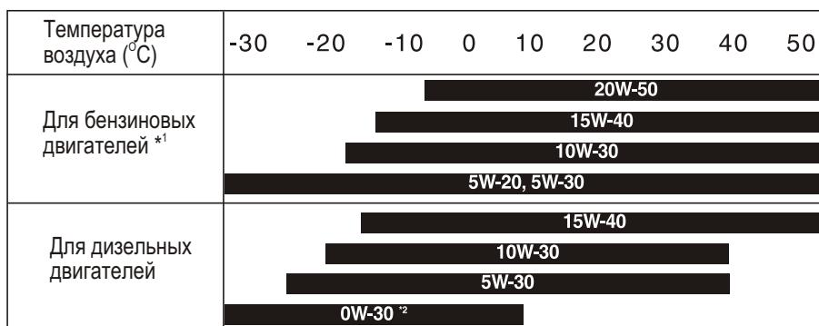
\*1 Для обеспечения максимальной экономичности и нормального запуска двигателя рекомендуется применять моторное масло с вязкостью SAE 5W-20, 5W-30 по классификации API SJ, SL / ILSAC GF-3.
