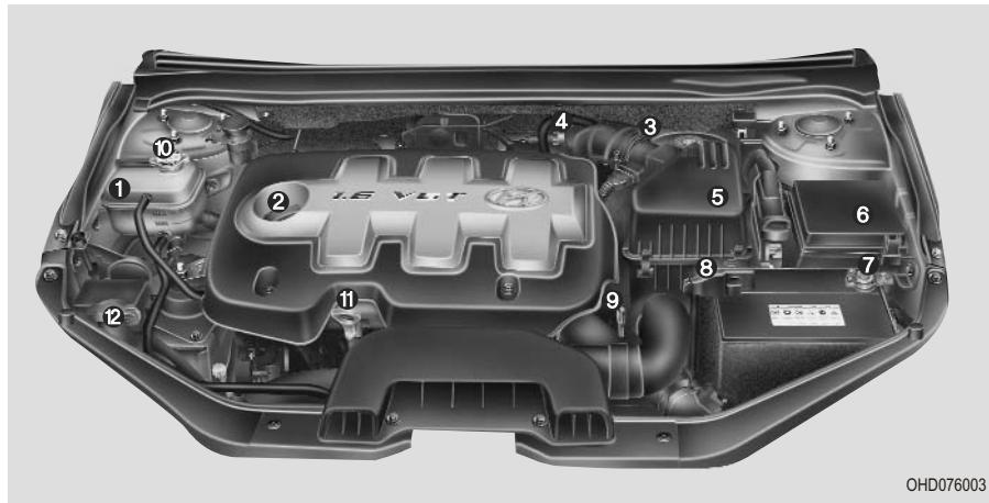
1. Бачок охлаждающей жидкости двигателя
