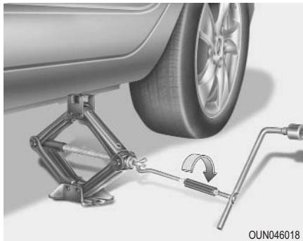
8. Вставьте баллонный ключ для затяжки колесных гаек в ручку домкрата как показано на рисунке. Чтобы поднять автомобиль, вращайте ручку домкрата по часовой стрелке. Поднимите автомобиль на достаточную высоту для установки полностью накачанного колеса. Для этого Вам понадобится поднять автомобиль выше (примерно на 30 мм), чем до того, чтобы снять спущенное колесо.
