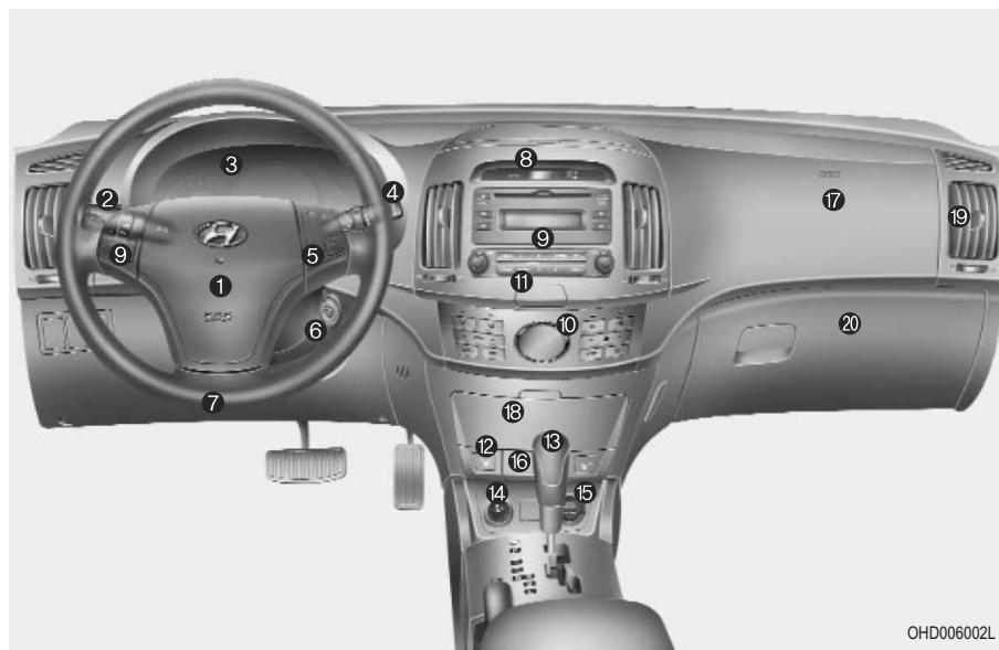
1. Звуковой сигнал и надувная подушка безопасности (для водителя)\* ..... 3-33
