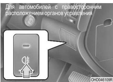
Чтобы включить задний противотуманный свет нажмите на выключатель. Задний противотуманный свет будет гореть, когда переключатель фар головного света находится в положениях (2) и (3) и включены передние противотуманные фары.
