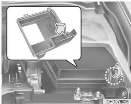
Если фары головного света не работают после замены предохранителя, проверьте и в случае необходимости замените дублирующие предохранители в моторном отделении.
