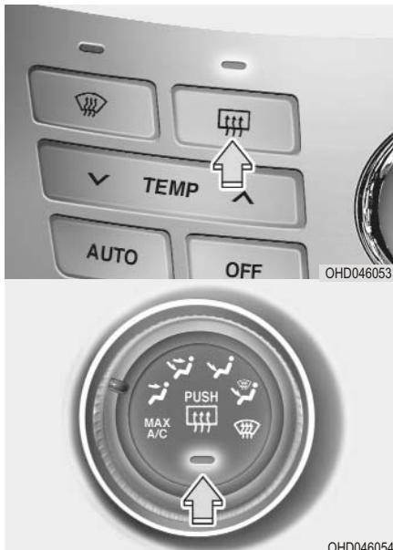
Для включения обогрева заднего стекла и наружных зеркал заднего вида нажмите на выключатель. При этом на выключателе загорится контрольная лампа. Если на заднем стекле скопилось большое количество снега, очистите стекло перед включением обогрева. Чтобы выключить обогреватель, повторно нажмите на выключатель. Обогрев будет автоматически отключен через 20 минут. Чтобы включить его еще раз, нажмите на выключатель после автоматического отключения обогрева.
