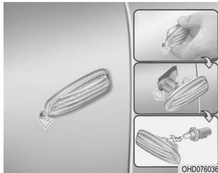
**Замена ламп боковых повторителей сигнала поворота (дополнительное оборудование)**
