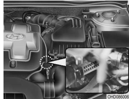
Номер двигателя выштампован на блоке цилиндров, как указано на рисунках.
