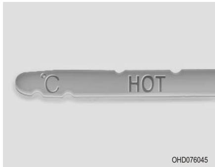
При нормальной рабочей температуре жидкости (приблизительно 70~80°C), уровень жидкости должен находиться в диапазоне "HOT" ("Горячий") на щупе.
