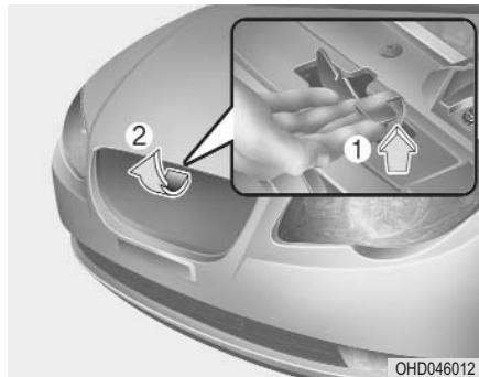
2. Подойдите к передней части автомобиля, поднимите немного капот и потяните к себе предохранительный рычаг (1), затем поднимайте капот вверх (2).
