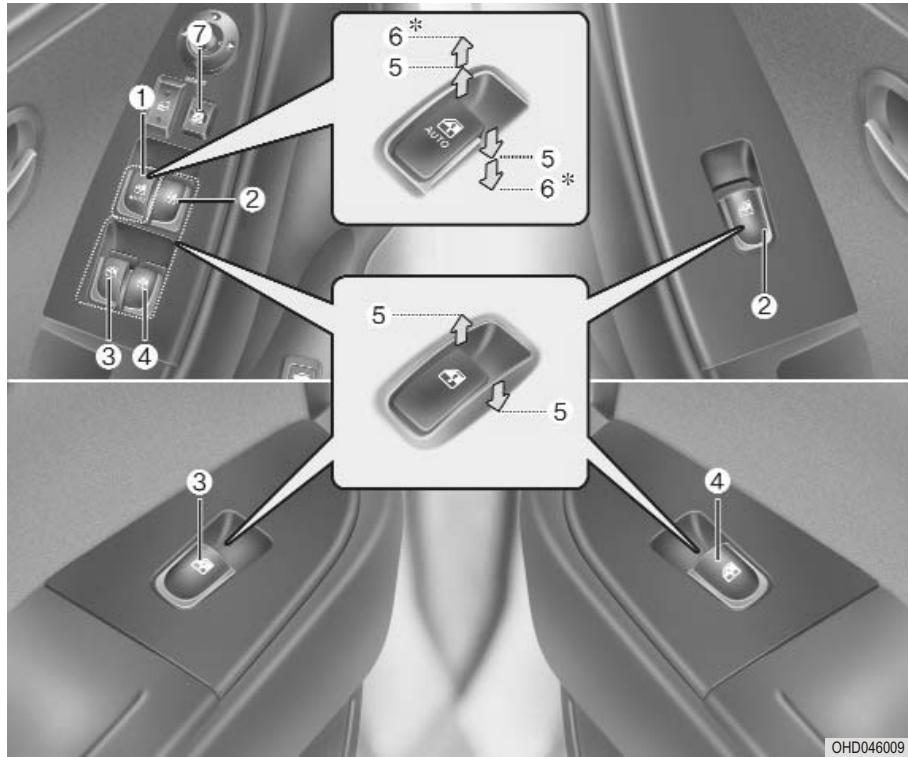
1. Переключатель электрического стеклоподъемника двери водителя.
