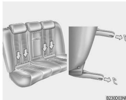
Монтаж удерживающего приспособления для детей с системой крепления "ISOFIX" должен производиться в соответствии с инструкцией Исполнителя этого устройства.
