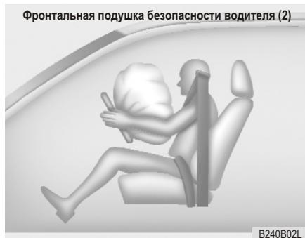
Во время раскрытия подушек безопасности, расширяющаяся при надувании газом подушка безопасности выбивает крышку, которая разламывается по специальному шву.
