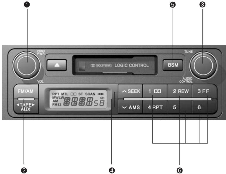
1. Выключатель питания, ручка регулировки громкости
