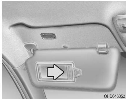
**Лампа подсветки косметического зеркала (дополнительное оборудование)**
