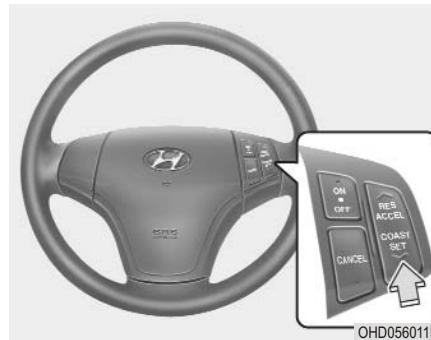
3. После установки желаемой скорости движения автомобиля нажмите на выключатель COAST/SET. При этом на панели приборов загорится индикатор SET. После этого снимите ногу с педали акселератора и скорость движения автомобиля будет автоматически поддерживаться.
