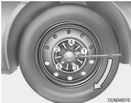
Установите ключ в показанное на рисунке положение и затяните колесные гайки. Убедитесь, что головка ключа плотно охватывает колесную гайку. При затяжке гаек крепления колеса запрещается вставлять ногой на баллонный ключ или удлинять последний посредством трубы, так как это может привести к перетяжке гайки.
