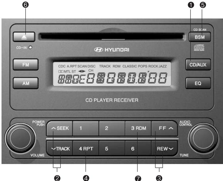
1. Кнопка выбора режима проигрывателя компакт-дисков
