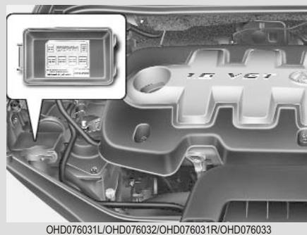
На внутренней стороне защитных крышек есть описание блока предохранителя, в котором указаны какая цепь электрооборудования защищена каждым предохранителем или реле, с указанием значений номинального тока
