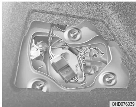
3. Извлеките патрон из корпуса фонаря, поворачивая его против часовой стрелки до тех пор, пока выступ на патроне не совместится с пазом на корпусе фонаря.
