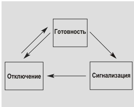
Эта система предназначена для предотвращения несанкционированного проникновения в автомобиль. Эта система имеет три состояния: первое - "Готовность", второе - "Сигнализация" и третье состояние "Отключение". При срабатывании противоугонной системы включается звуковая сигнализация (сирена) и начинают мигать указатели поворотов.
