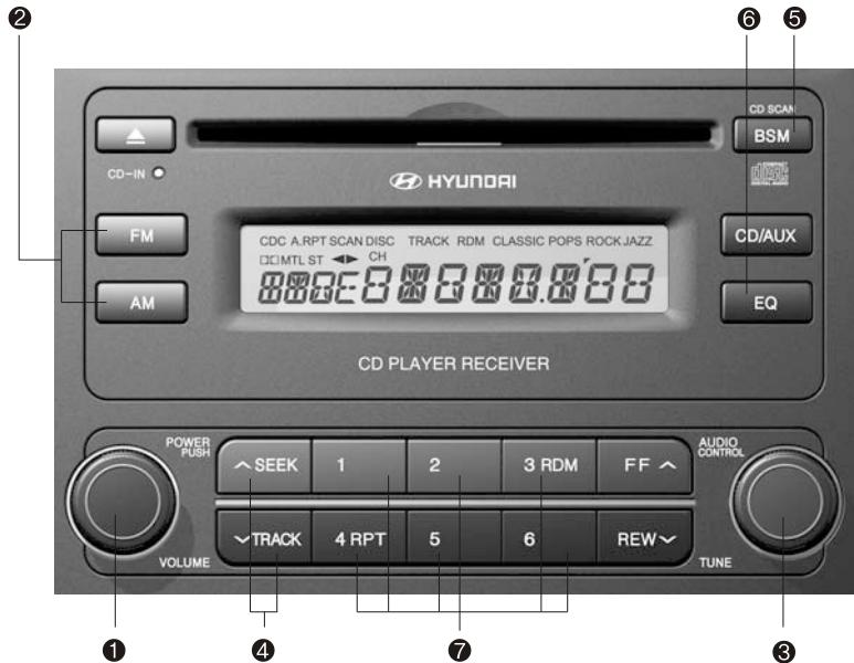
1. Выключатель питания, ручка регулировки громкости
